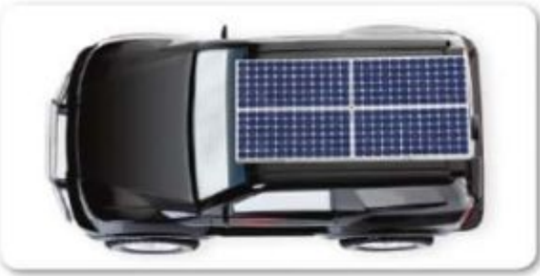
الشكل 17 تحوّل الخلايا الكهروضوئية الطاقة الإشعاعية إلى طاقة كهربائية. لبعض الموديلات أواج كهروضوئية اختيارية مصنوعة من خلايا شمسية تستخدم لتزويد السيارة من دون استخدام المحرك.
