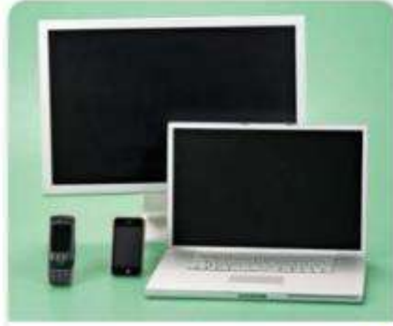
الشكل 12 تستخدم الكثير من أجهزة الموضة والإلكترونيات الصغيرة مثل تسمّلات MP3 والهواتف المحمولة وأجهزة التلفزيون والحواسيب المحمولة الصغيرة (أنت بوك) شاشات بلورات سائلة (LCD).
