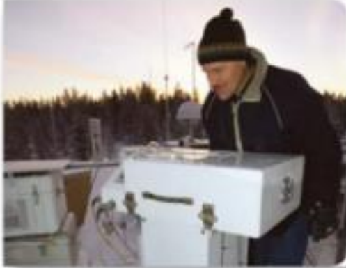
الشكل 4 يستخدم العلماء مجموعة متنوعة من المعدات، بما في ذلك مطياف Brewer، لقياس الأوزون.
