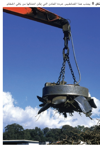
الشكل 8 يجذب هذا المغناطيس حردة المعادن التي يمكن انشائها من باقي الحطام.
