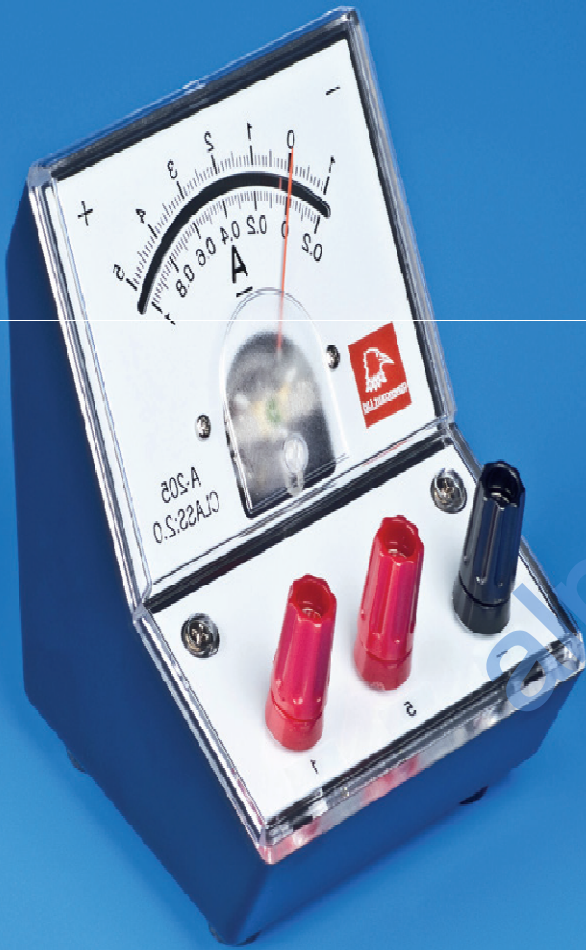
الأميتر يقيس شدة التيار الكهربائي.
