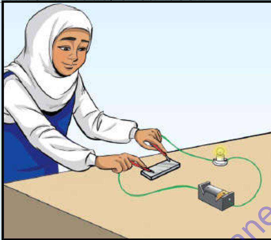
اختبر كل مادة من المواد عن طريق توصيل الطرف المكشوف لأحد الأسلاك ليلامس طرف الجسم الذي تريد اختباره مع توصيل السلك المكشوف الثاني بالطرف الآخر للجسم.
