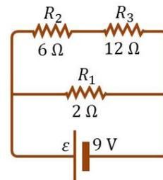
أفترض أن التيار ( $I_1$ ) يسري في العروة العليا باتجاه عقارب الساعة وأتحرك من نقطة التفرع (a)
