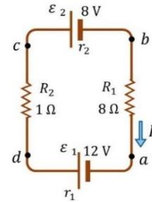
أستنتج من الإشارة الموجبة أن اتجاه التيار بالاتجاه المفترض؛ أي إن التيار يسري في الدارة مع اتجاه عقارب الساعة. وهو تماماً ما تم استنتاجه في حل المثال عندما افترضت اتجاهها مختلفاً للتيار. وأستنتج أنني أتوصل إلى اتجاه التيار الحقيقي بغض النظر عن الاتجاه الابتدائي الذي افترضه لسريان التيار.
